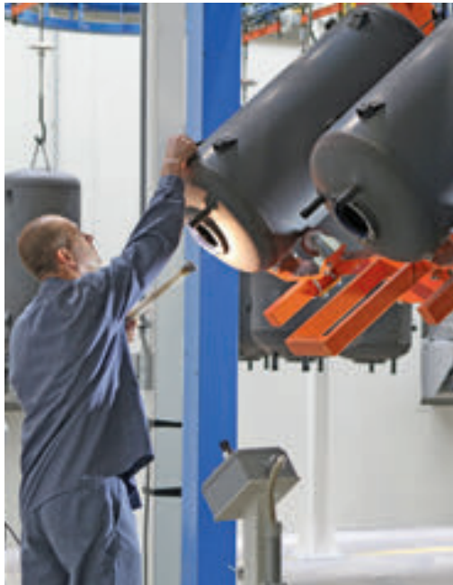
Inspección visual del interior de las calderas antes de añadir la carcasa exterior.
