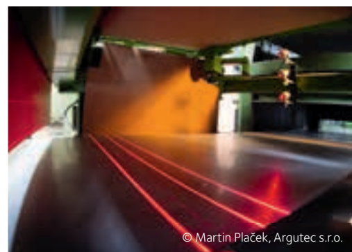
Le système Shape Scan installé à ArcelorMittal Frýdek-Místek mesure la planéité de la bande à l'aide de lasers.
