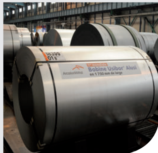
La prima bobina di ampiezza superiore Usibor® Alusi® prodotta nel dicembre del 2012
