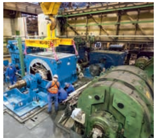
Ansamblul noului motor sincron pentru laminorul tandem de bandă laminată la rece (stânga) și un motor de curent continuu de generație veche (dreapta).
