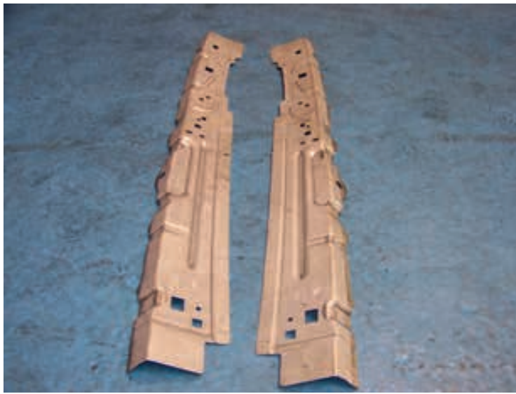
Prototip de stâlpi de parbriz ambutisați la rece după operațiile de debitare și vopsire.
