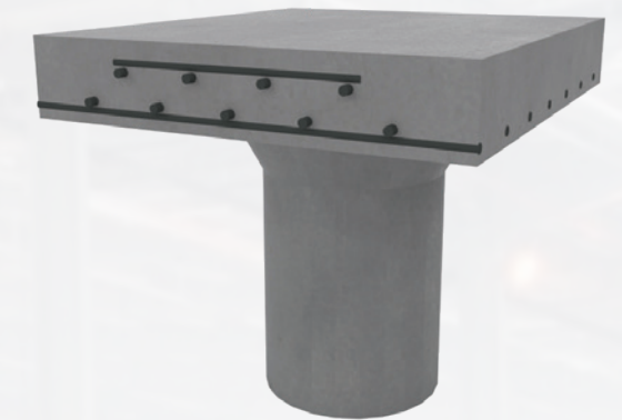
Pfahlgestützte Bodenplatte mit traditioneller Bewehrung
