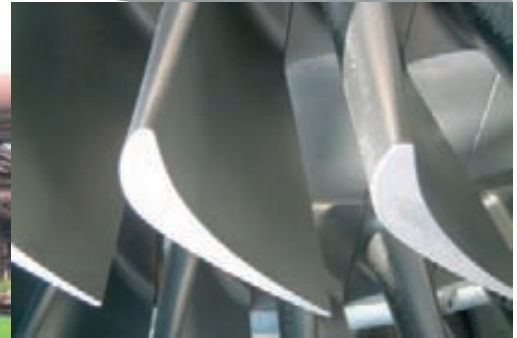
Los gases de horno alto se limpian antes de hacerlos pasar por el TRT para generar electricidad. El gas todavía puede utilizarse en otras partes de la planta para generar calor y energía para otros procesos.
