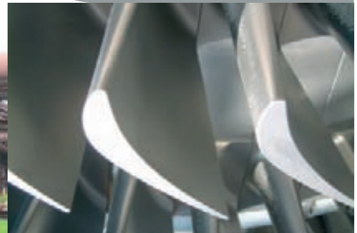
Rookgassen worden gezuiverd voordat ze door de TRT geleid worden om elektriciteit te produceren. Het gas kan daarna nog steeds gebruikt worden in andere delen van de fabriek om warmte of energie op te wekken voor andere processen.
