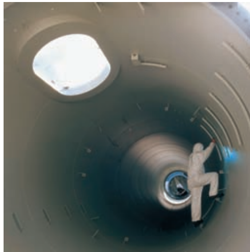
Ocelový stožár prochází před dopravou na určené místo finální kompletací
