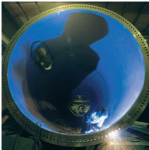
Ocelový stožár prochází před dopravou na určené místo finální kompletací
